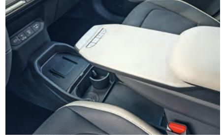
Die ausziehbare Ablagefläche der Mittelkonsole erlaubt das Abstellen eines Laptops.
