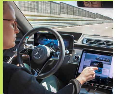
Oben links: Auf deutschen Autobahnen dürfen hochautomatisierte Fahrzeuge ab Frühjahr 2025 selbstständig bis zu 95 km/h schnell fahren. Oben rechts: Der Autofahrer darf sich währenddessen einigen fahrfremden Tätigkeiten zuwenden und den Blick vom Verkehr wegdrehen.
