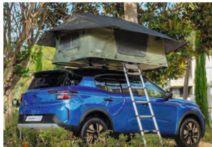
Dank einer statischen Dachlast von 240 Kilogramm lässt sich ein Dachzelt aufstellen.
